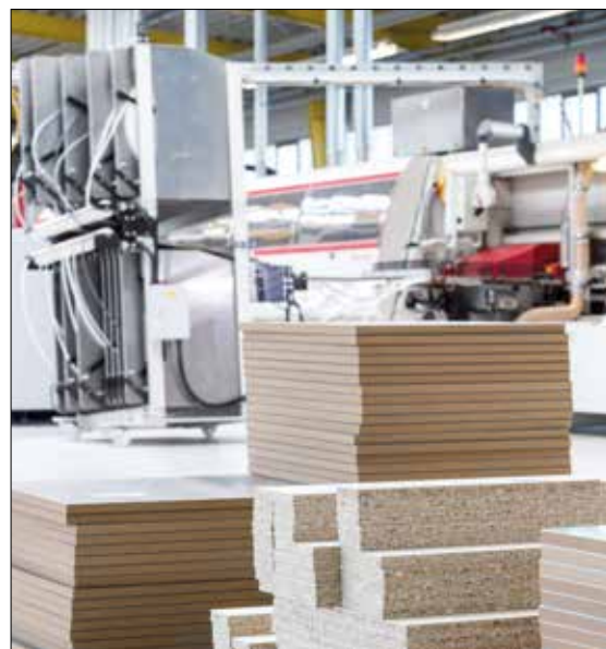
IMA Laser Edging, IMALUX oder konventionelles Verleimen für widerstandsfähige Nullfugen
