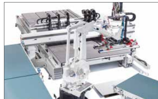
Roboter zum Beschicken und Stapeln einzelner Prozessschritte
