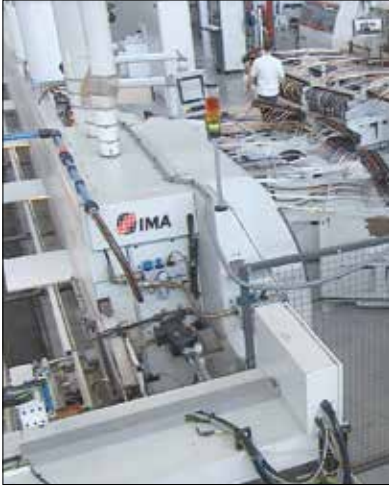
Bedienerfreundliche U-Anordnung der Maschinen mit zentralem Kantenmanagement
