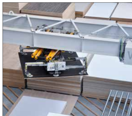
Dreheinrichtung der Vakuumtraverse für lagerrichtige Beschickung der Aufteilsanlage
