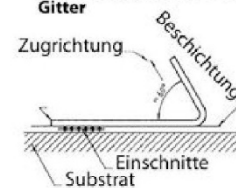
b) Position des Klebebandes kurz vor dem Abriss vom Gitter
